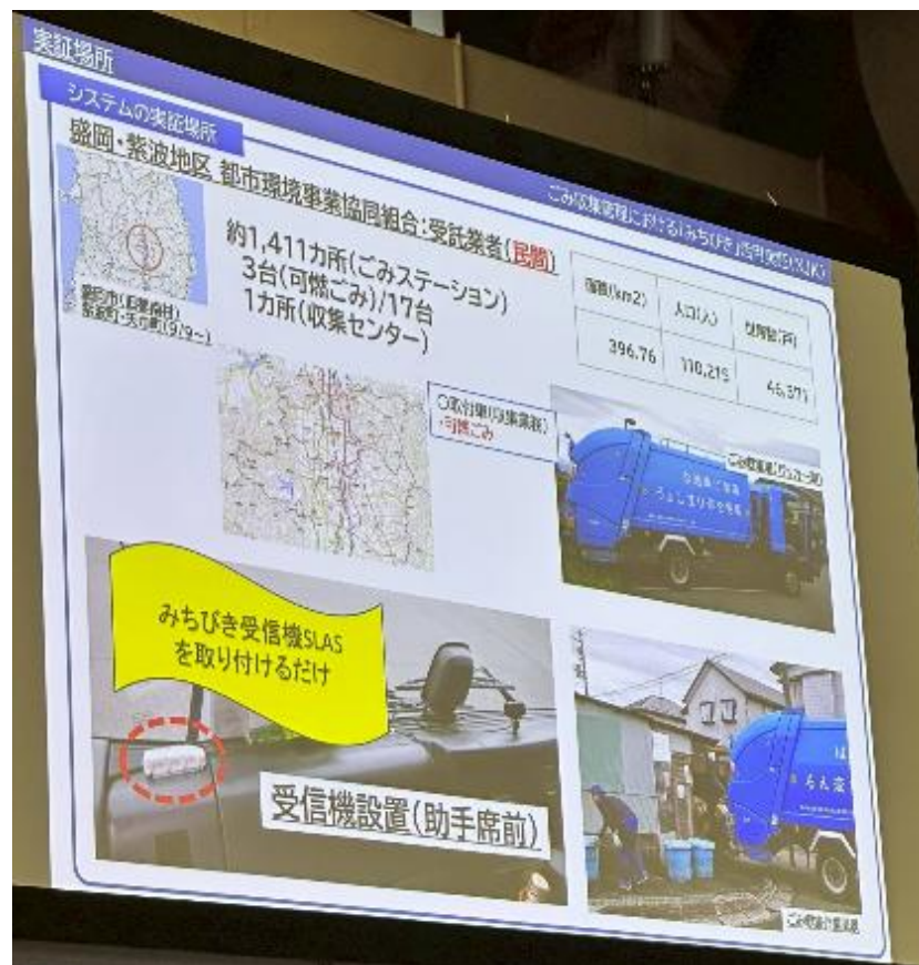
圖10、在副駕駛座前設定衛星接收器 的垃圾收集管理系統 資料來源：本計畫自行拍攝
