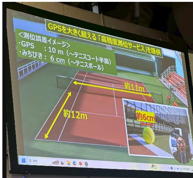
圖8、遠超過GPS的高畫質服務（GPS約10平分公尺網球場，衛星可拍出6CM的網球） 資料來源：本計畫自行拍攝
