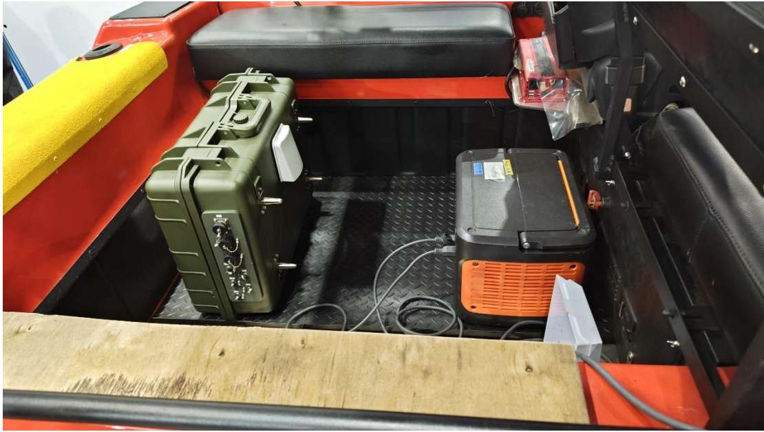
圖 19、東京大學中尾研究室展示之山區救難車：小型可攜式 Local 5G 基地台結合低軌道衛星回傳鏈路與電池
